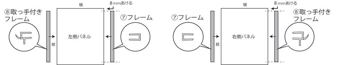
縦フレームの上側は8mmあけて取り付けして下さい。
