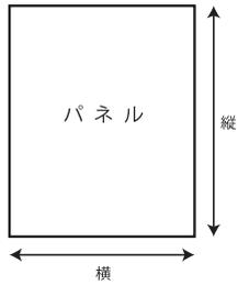
測った寸法の高さ、幅をもとにして切断寸法を出します。
